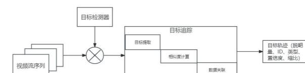
图 1 目标追踪测试流程
