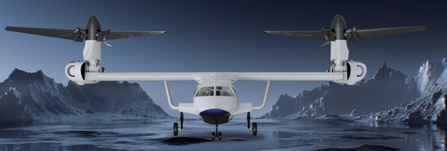
联合飞机TD550 应急通信型无人直升机系统搭载机载卫通设备、光电吊舱、公网通信设备等载荷，超视距飞行至57公里处后第一时间确认着火点位置及火势情况，全面侦察村屯受灾情况，及时传回村民生活与物资需求后安全返航。无人直升机通过卫通将现场高清视频实时回传至现场指挥车及省厅指挥中心，为现场救援决策提供信息支撑。
