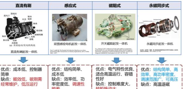
图2 四种形式的起发电机对比
