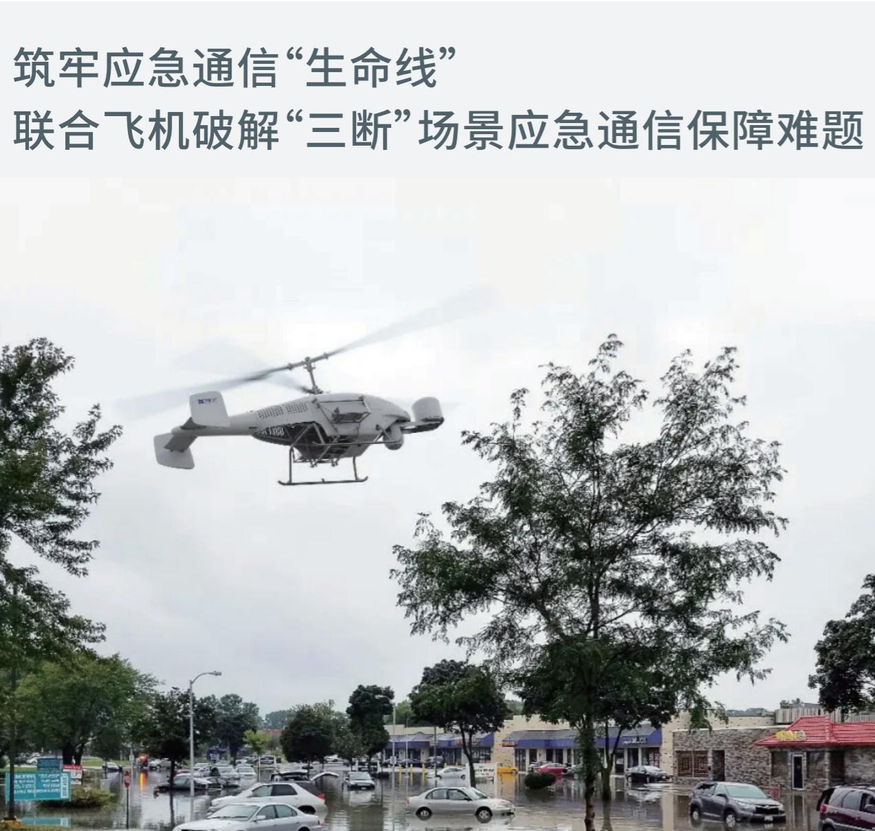
聚焦“三断”场景的无人机航空应急能力建设，针对高寒、高海拔、海上、山区等环境出现的大震巨灾，导致的大范围区域通信失联、群众受困。联合飞机依托大载重、长航时、高海拔、多任务能力、安全可靠的无人直升机，着力破解应急通信保障难题，加快大型无人直升机救援平台的研制，满足应急通信保障、灾情实时侦察以及应急物资投送等需求，形成TD550应急通信型无人直升机系统。该系统在典型环境下进行飞行验证及功能演示，取得了多省应急部门的赞誉，并逐项完成第三方机构产品鉴定，强化经验，做法凝练，为全国多地应急指挥通信保障提供智能无人应急救援装备、组建力量、强化能力。
