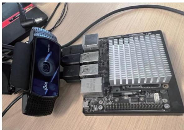
图9 边缘部署实验测试设备, Jetson xiaver nx和摄像头
