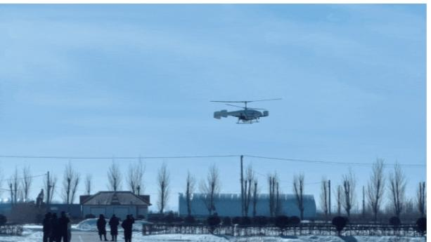
相比于固定翼无人机，无人直升机无需专用跑道或开阔的空间，即可垂直起降、低速悬停作业，适应更丰富的场景；相比于垂起固定翼无人机，无人直升机又能在固定的预设高度与水平位置进行悬停作业，在巡查、运投、检测等任务中具有明显优势；相比多旋翼无人机，无人直升机具有载重大、航时长、速度快、范围广等优点。
