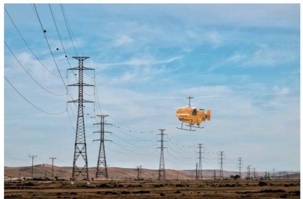
针对架空线路和变电站的巡检任务，TD220不受地理环境的限制，可对长输电线路进行快速、重点范围巡检，
