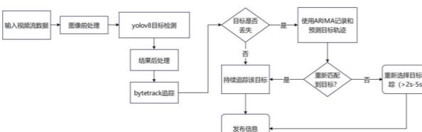
图8 无人机目标检测追踪系统流程图
