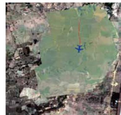
图4无人机影像与卫星影像匹配定位
