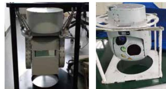
a自研扫描式激光雷达 b可见光/红外吊舱
