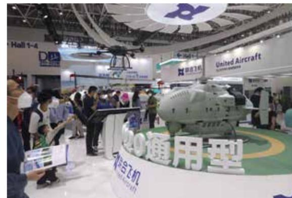
高海拔地区与平原地区的自然条件差异极大，联合飞机TD550共轴无人直升机具有载重大、飞行速度快，续航时间长，可高海拔起降等性能优势，可以覆盖更多地区，满足持续性作业要求。同时，它的结构简单、拆装便捷、易于安装，装机尺寸小，大大降低了制造、维护与运输成本。
