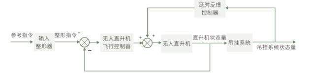
图3-1 协调运动控制系统架构图
