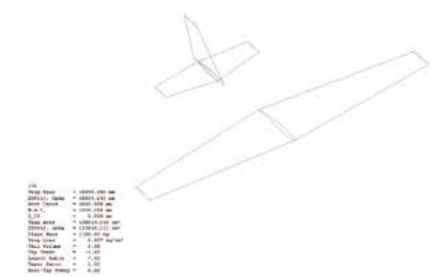
图9 基于XFLR5创建的几何模型
