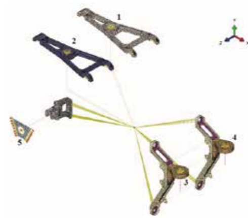
图 2 动力总成系统的有限元模型
